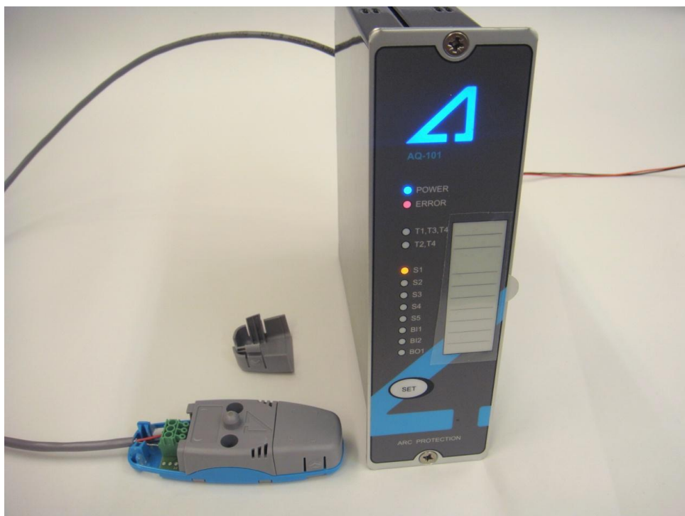
Obr. 4-11: AQ01 Krok 6 připojení čidla.
