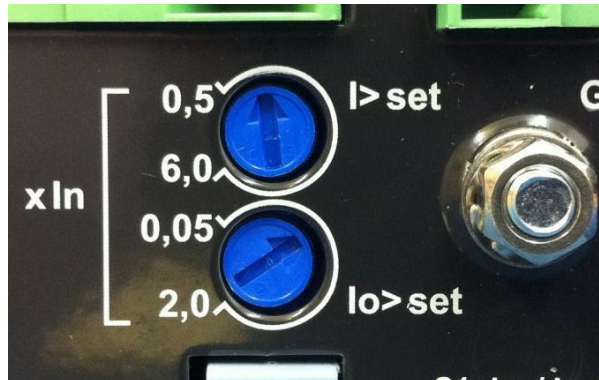
Obr. 3-1 AQ110 Trimry pro nastavení nadproudu
