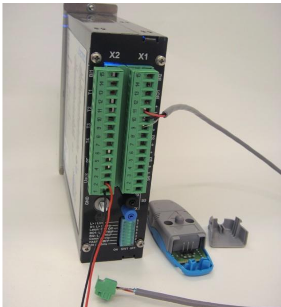
Obr. 4-8: AQ01 Krok 3 připojení čidla.
