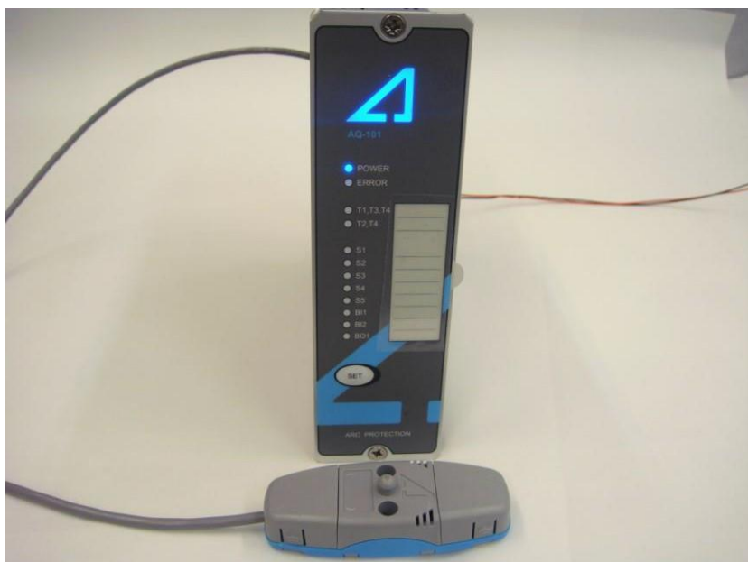
Obr. 4-13: AQ01 Krok 8 připojení čidla
