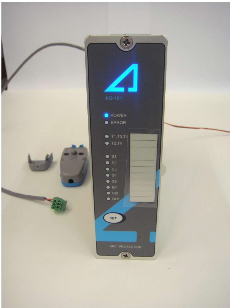
Obr. 4-9: AQ01 Krok 4 připojení čidla.
