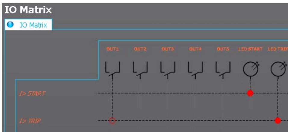
Obrázek 8.3.1-5 Vypínací kontakt IED použitý pro vypnutí vypínače musí být bez přídrže.
