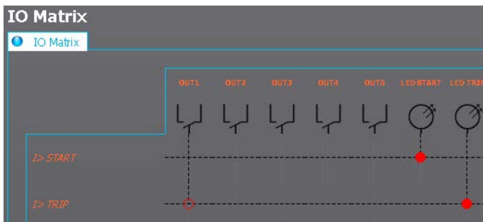
Obrázek 8.3.1-5 Vypínací kontakt IED použitý pro vypnutí vypínače musí být bez přídrže.
