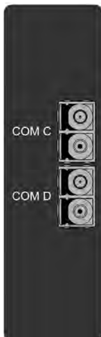
Obrázek. 8.10. - 211. Konektory modulu LC 100 Mbps Ethernet.
