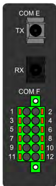
Obrázek. 8.9. - 210. Konektory modulu sériového RS-232.
