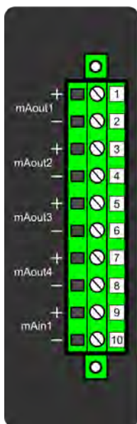
Obrázek. 8.13. - 218. Svorky miliampérového modulu (mA) I/O.
