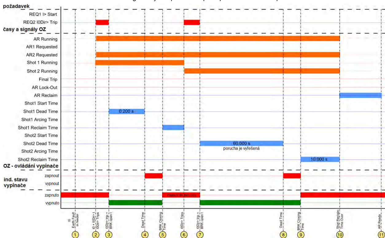
Obrázek. 5.5.4. - 136. Graf stavu signálů cyklu opětného zapnutí při částečné zemní poruše.
