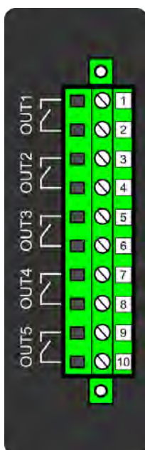
Obrázek. 8.6. - 206. Modul digitálních výstupů (DO5) s pěti přidavnými digitálními výstupy.
