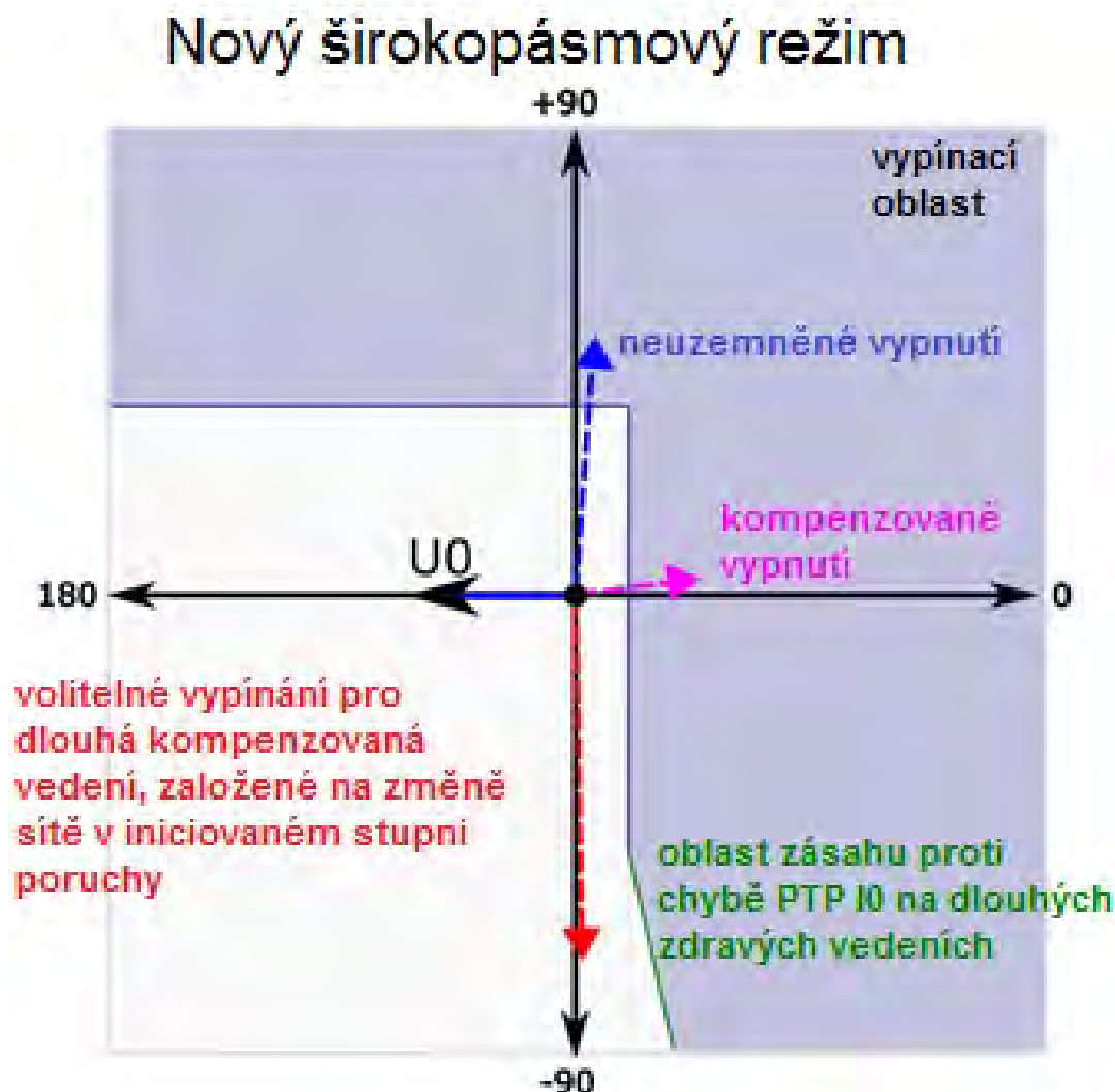
Obrázek. 5.4.5. - 44. Sledování úhlu funkcí I0dir&gt; (režim širokopásmového rozsahu).
